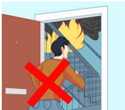
ኣብ ናይ ካልእ ሰብ ገዛ ሐዊ እንተ ተላዒሉ፣ እሞ ኣብ መደያየቢ መሳልል ትኪ እንተሉ፣ ኣብ ውሽጢ ገዛኻ ጽናሕ።
